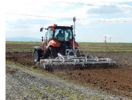
レーザーレベラーによる均平作業
