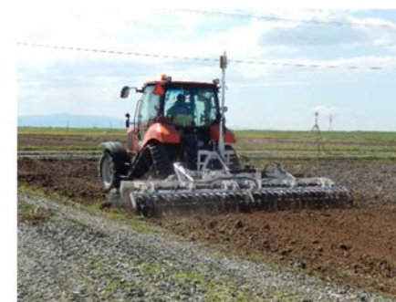
レーザーレベラーによる均平作業
