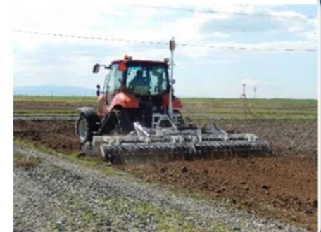
レーザーレベラーによる均平作業
