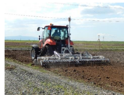
レーザーレベラーによる均平作業
