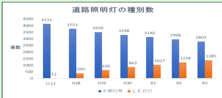
道路照明灯のLED化により、電力使用量を約30%削減 (平成27年度比)
