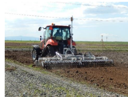
レーザーレベラーによる均平作業
