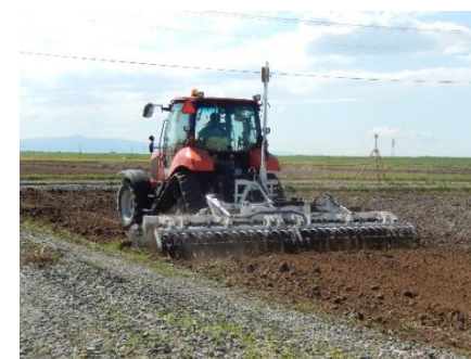
レーザーレベラーによる均平作業
