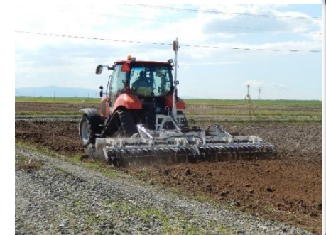
レーザーレベラーによる均平作業
