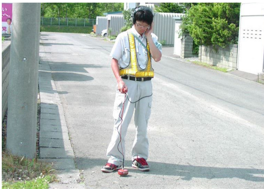
図 漏水調査をしている写真
