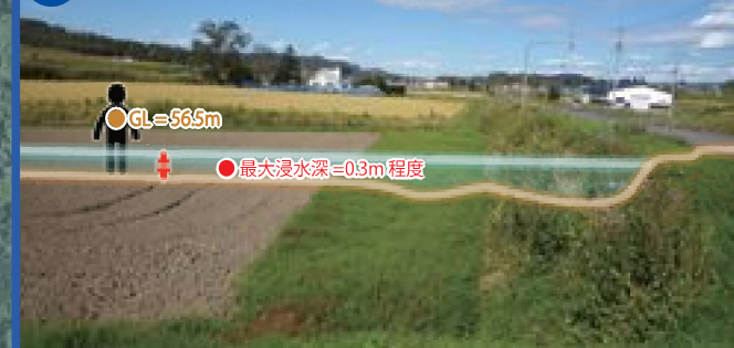
3 最大浸水深イメージ(ダムから2.7km下流地点)
