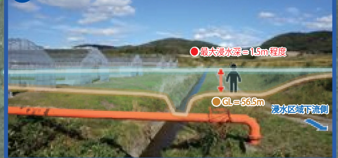
2 最大浸水深イメージ(ダムから1.2km下流地点)
