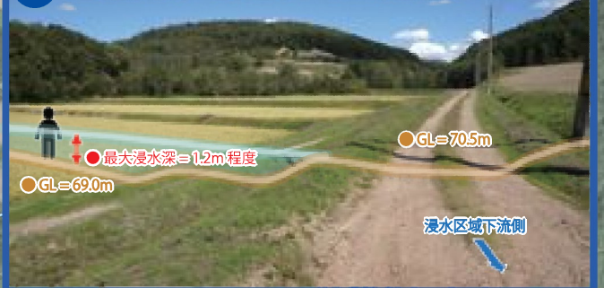
1 最大浸水深イメージ(ダムから0.6km下流地点)
