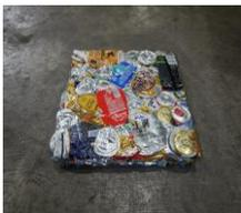
缶やペットボトルは「いわ☆ぴか」に運ばれた後、機械で圧縮して1つのかたまりにする作業をします。
