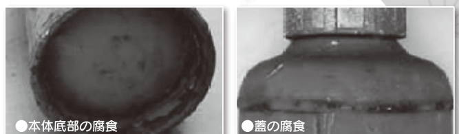
破裂する恐れがある消火器の例
