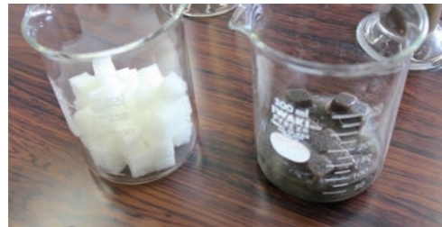
担体はスポンジ状で、使用前（左）は白く、微生物が固定化（右）すると黒くなります。この中にたくさんの微生物が住んでいます
