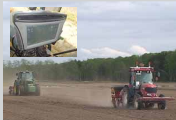
ICTを活用したトラクター運転とガイダンス機器
