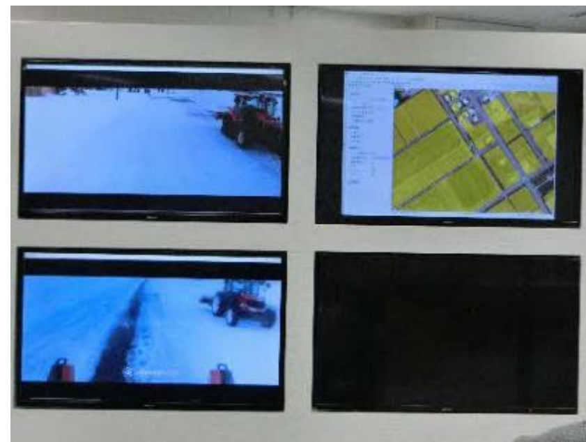
遠隔監視センターにおけるスマート農機（2台）の 遠隔監視・制御の様子
