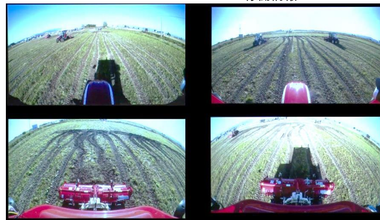
5G技術を活用した2台のスマート農機（無人トラクター）の前後に取り付けたカメラ映像
