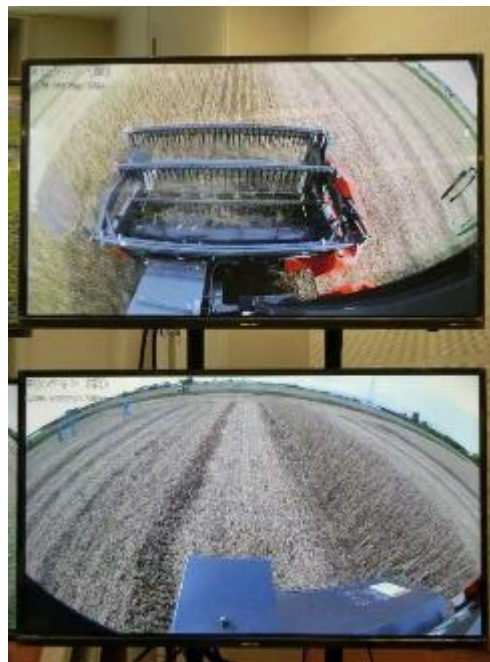
自動運転アシストコンバインの前後に取り付けた5G技術を活用したカメラ映像
