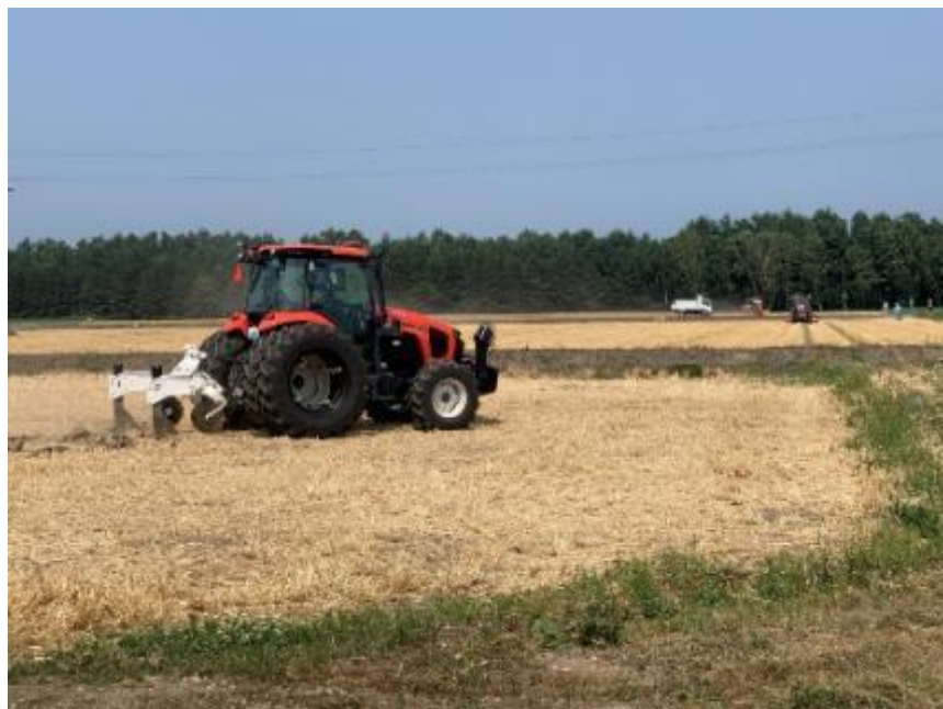
3台のスマート農機（自動運転アシストコンバイン・ロボットトラクター）の遠隔監視・制御による収穫、残渣処理、心土破碎作業の様子
