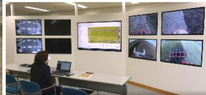
遠隔監視センターにおける2台のスマート農機の 遠隔監視・制御の様子
