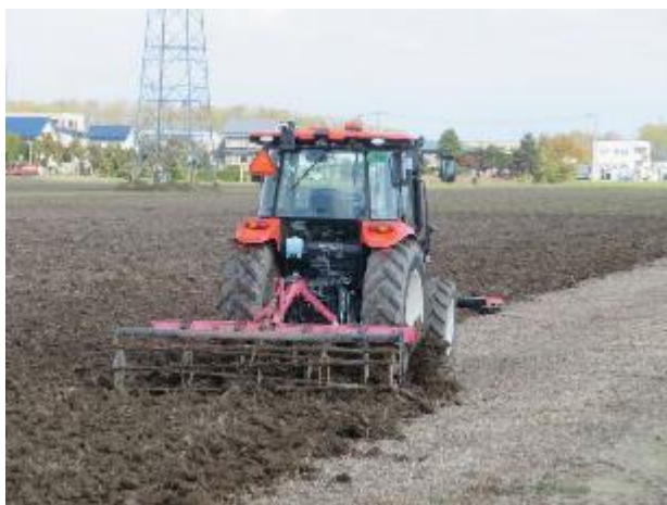
スマート農機（ロボットトラクター）による 整地（スタブルカルチ）の無人作業
