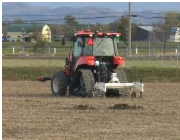
スマート農機（ロボットトラクター）による 心土破碎（サブソイラ）の無人作業
