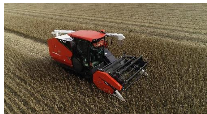
5G活用による遠隔監視制御で 実施した大豆の無人収穫作業
