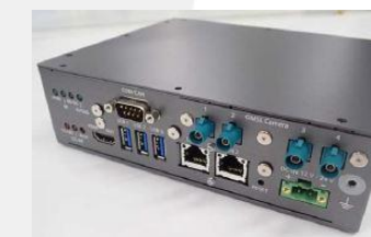
遠隔監視に必要な農機搭載 システムの小型化（遠隔監視 エンコーダー体型ルータ端末）
