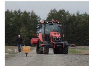
障害物を遠隔操作で回避するロボットトラクター
