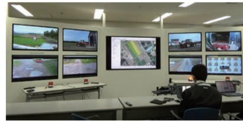
複数箇所に配置したロボットトラクターを遠隔監視
